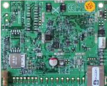
zum Einbau in eine SmartCell Funk-Brandwarnanlage für SMS-/E-Mail-Meldungen von Alarm-, Stör- und Statusreports über die SmartCell Services-Cloud
