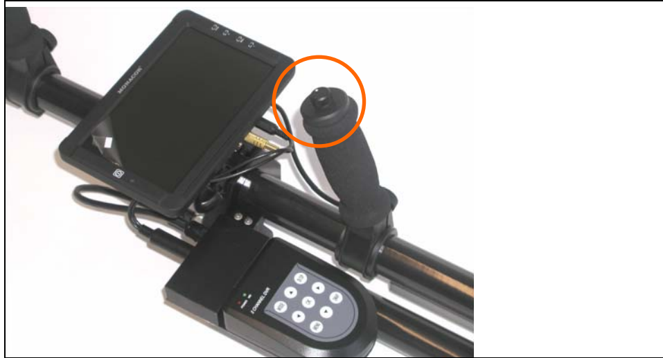
Abb. 5.2 Fernbedienungs-vorrichtung zur Einstellung des Kamerawinkels
