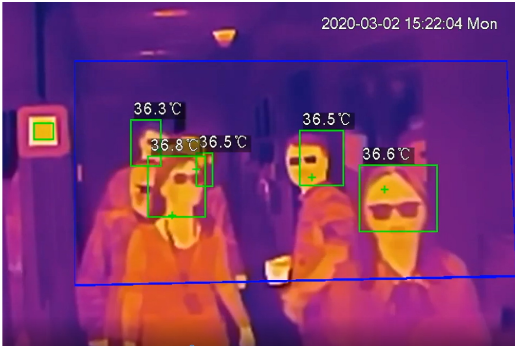
Wärmebild mit Anzeige der gemessenen Körpertemperatur
