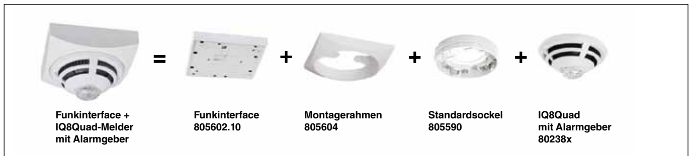
Aufbau Funkinterface mit IQ8Quad Melder
